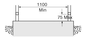
[Diagram 5.E] Edge Protection for Ramps
